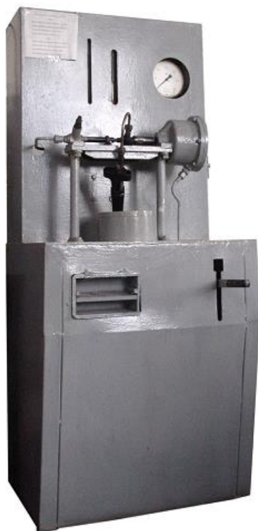
Рис.1. Опрессовочный стенд типа А106 (а) и модернизированный стенд с указанием дополнительно установленного оборудования (б): 1 – блок индикации, сбора, обработки и передачи данных; 2 – тензoeлектрический датчик давления топлива в трубопроводе высокого давления стенда; 3 – датчик линейного перемещения хода плунжера насоса стенда.
