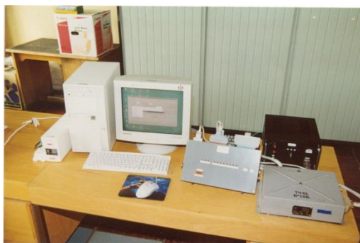
Рис. 4. Автоматизированный стенд тестирования и диагностирования электронных модулей локомотива
