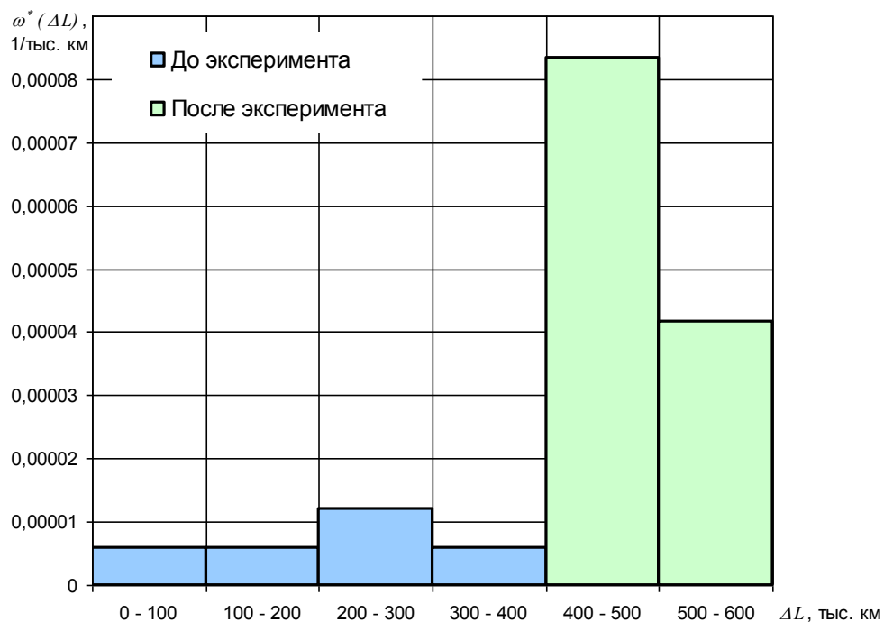
Рисунок 6 – Диаграмма параметра потока отказов стержней люлечного подвешивания
