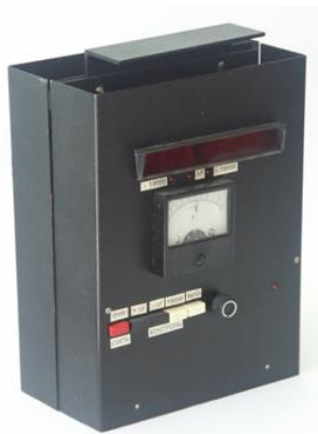
Рис. 3. Двухканальное устройство для защиты ТК от разноса и помпажа
