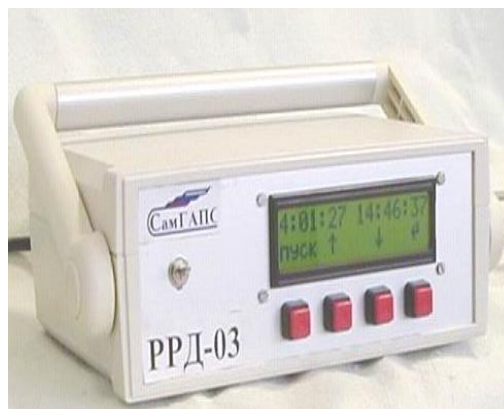
Рис. 5. Устройство для учета загрузки дизель-генераторной установки тепловоза
