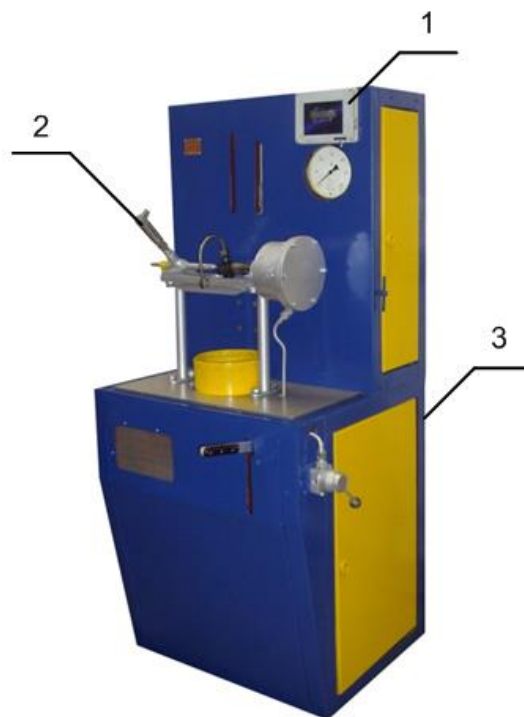
Рис.1. Опрессовочный стенд типа А106 (а) и модернизированный стенд с указанием дополнительно установленного оборудования (б): 1 – блок индикации, сбора, обработки и передачи данных; 2 – тензoeлектрический датчик давления топлива в трубопроводе высокого давления стенда; 3 – датчик линейного перемещения хода плунжера насоса стенда.
